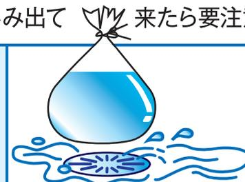
家庭ゴミ袋(15~20L位)に水を入れてしっかりヒモで結びます。破れやすいので二重に。材質がソフトなので、家庭内排水口の狭い部分も塞ぎやすく、逆流現象を発見した時に即対応すれば被害が少なくなると思います。ゴミ袋の常備をすればしてください。
